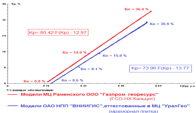
Рис.1. Сравнительные замеры центрированным прибором КСПРК-Ш-48 №5 на карбонатных моделях водонасыщенной пористости МЦ Раменского и МЦ «ВНИИГИС». Заполнение скважин моделей – пресная вода.
