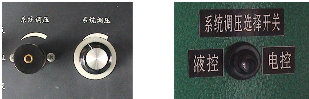
Рис. 2. Поворотная кнопка для управления давлением системы и переключатель
