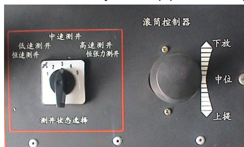
Рис. 1. Рукоятка управления и переключатель режимов
