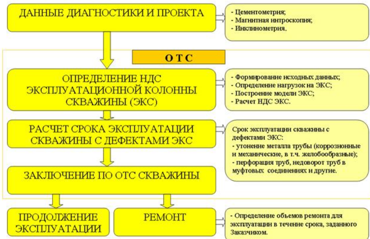
Рис. 1. Структура ОТС скважин
