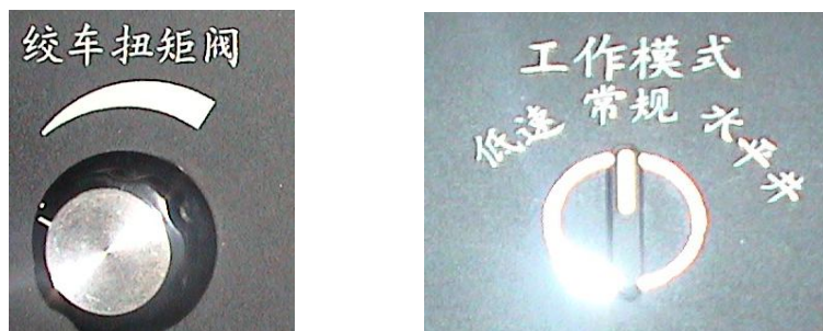
Рис. 9. Рукоятка управления барабаном и пульт управления
